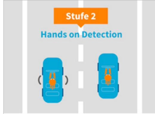
Teilautomatisiertes Fahren ermöglicht etwa automatisches Einparken und Spurhalten. Der Autolenker ist permanent in der Fahrverantwortung.
