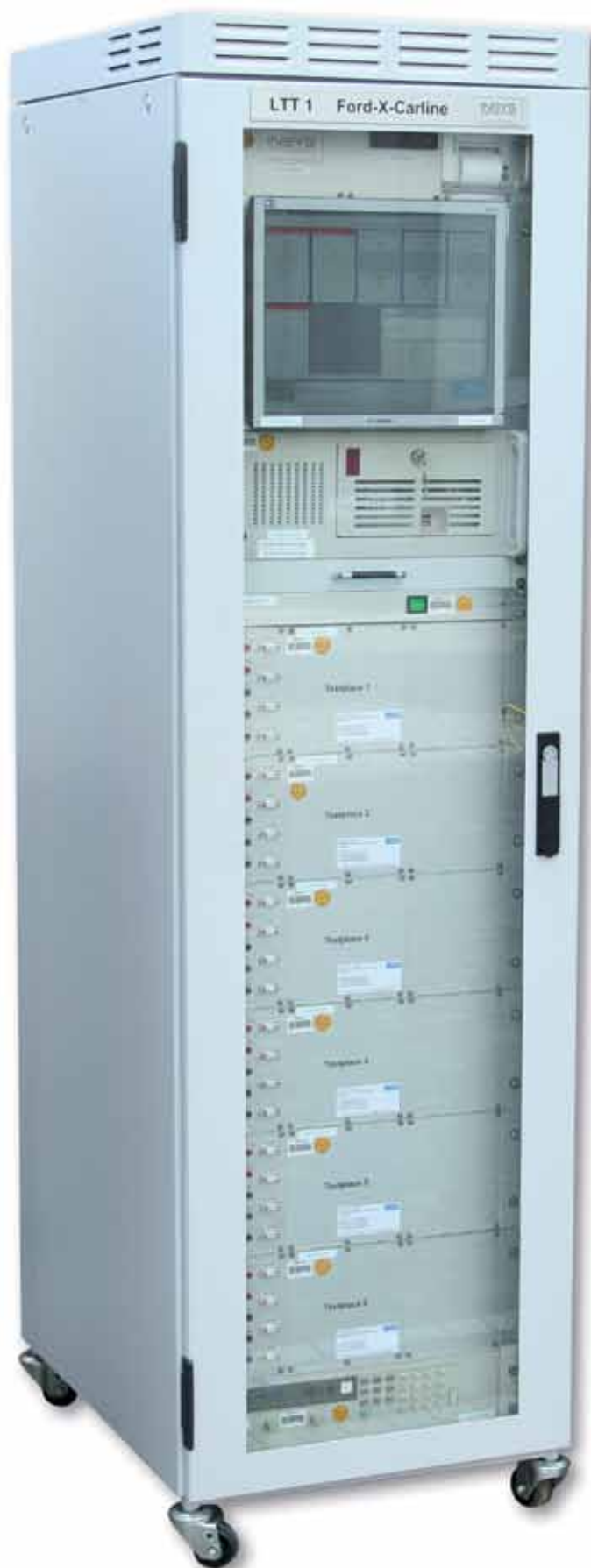
Ein komplett ausgestattetes Rack für Prüf- und Testverfahren von Steuergeräten im Automotive-Bereich.
