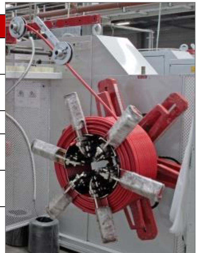
Herstellung von Kunststoffrohren mittels Extrusion bei der Maincor Rohrsysteme GmbH
