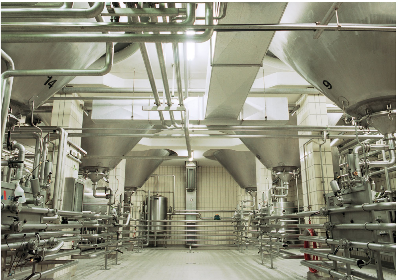
Abbildung 15: Gär- und Lagerkeller (Quelle: Deutscher Brauer-Bund e. V.)
