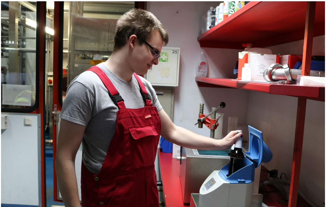
Abbildung 7: Biertrübungsmessung (Quelle: König-Brauerei GmbH/Oliver Landsberger)
