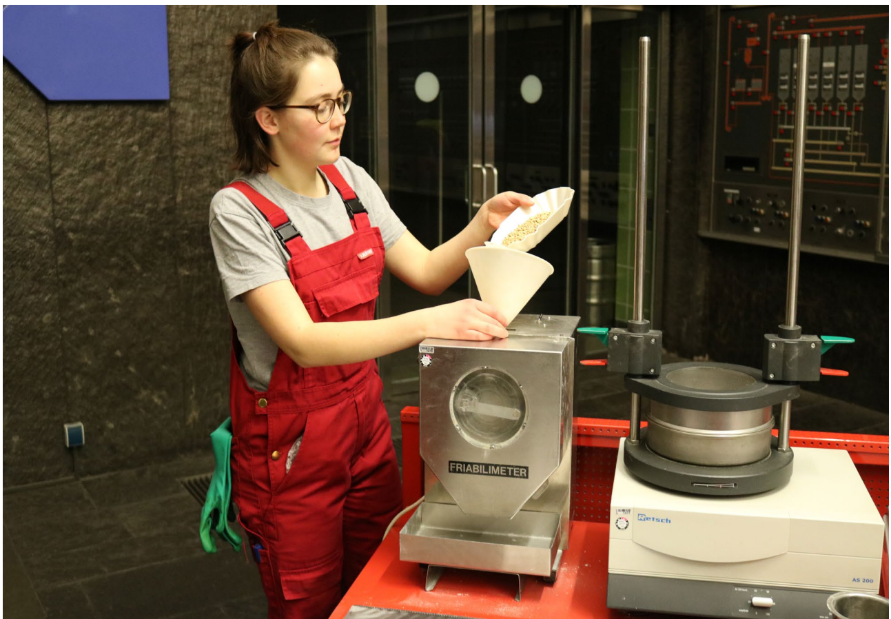
Abbildung 16: Malzanalyse mit einem Friabilimeter (Quelle: König-Brauerei GmbH/Oliver Landsberger)
