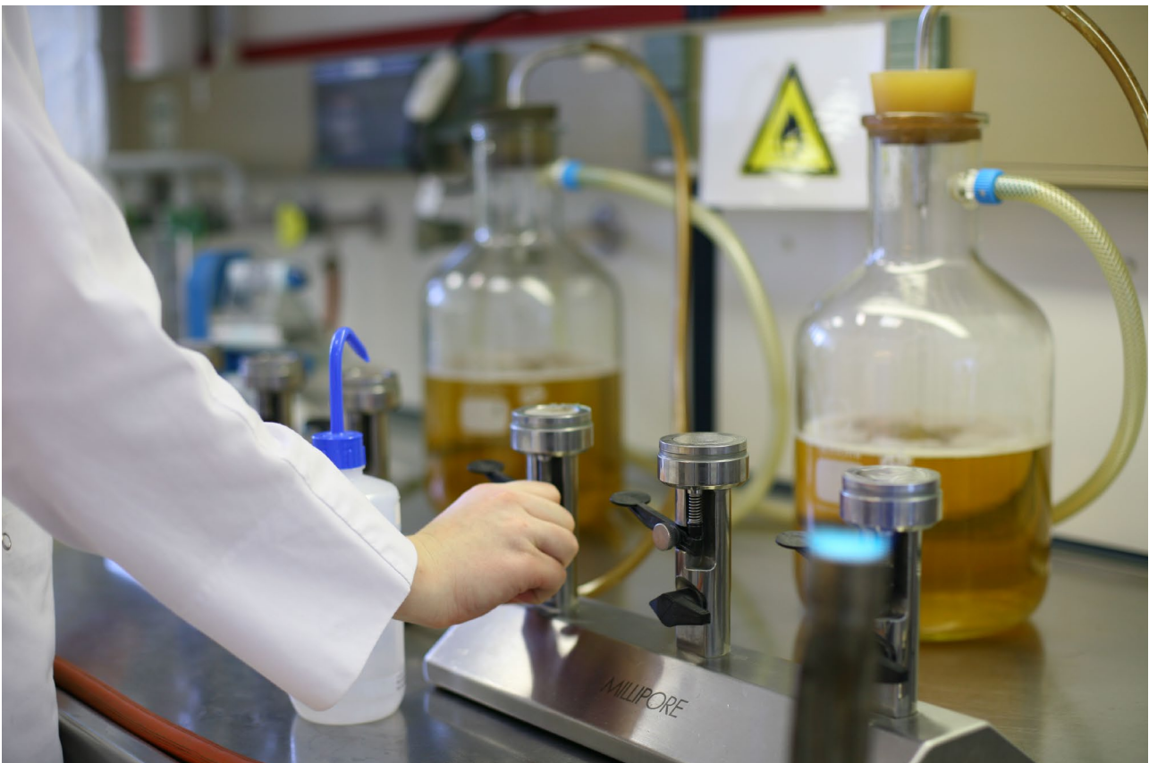
Abbildung 3: Membranfiltration in der Mikrobiologie (Quelle: Deutscher Brauer-Bund e. V.)
