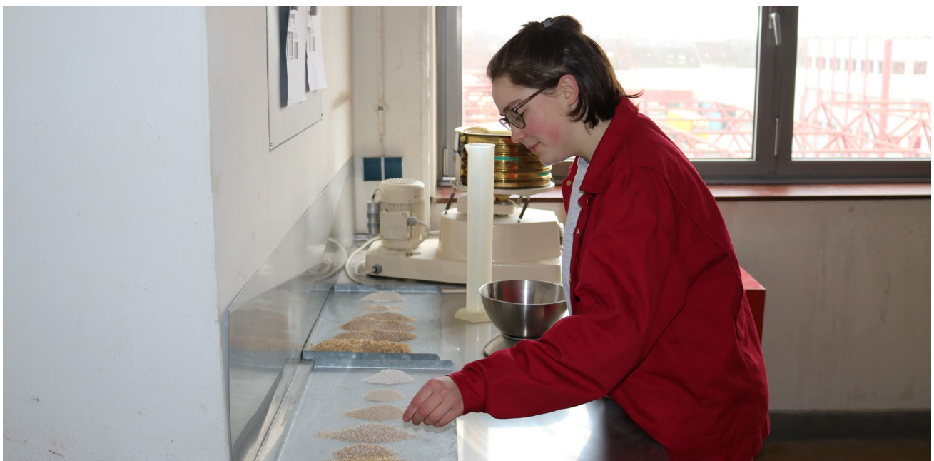
Abbildung 17: Malzschrotsortierung (Quelle: König-Brauerei GmbH/Oliver Landsberger)
